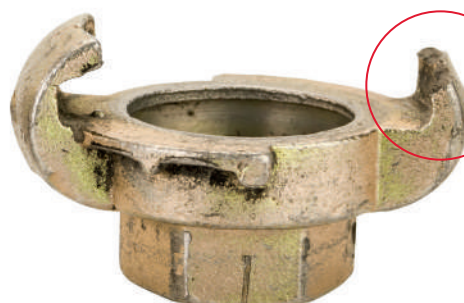
Plagiat aus Fernost (kein Herstellerkennzeichen, minderwertiges Material)
