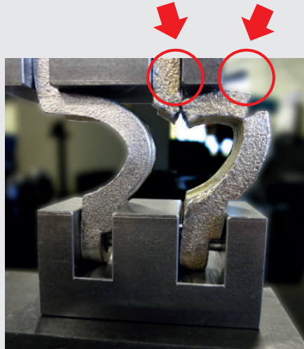
Abstand: 28 mm (kein Riss bei der LUDECKE -Schlauchklemme – Komplettbruch des Fremdproduktes)
