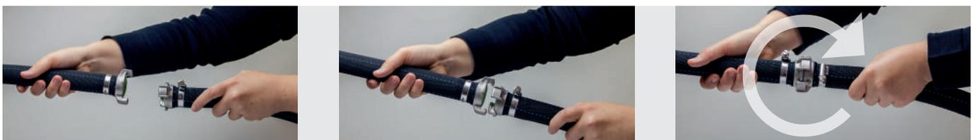
Der Kupplungsvorgang ist identisch mit der Funktionsweise der WaterProfi Klauenkupplungen. Die beiden Kupplungen werden stirnseitig versetzt zusammengeführt, sodass die Dichtflächen in Kontakt kommen. Anschließend ist eine Kupplungshälfte gegenüber der anderen Hälfte bis zum Anschlag zu verdrehen - die Kupplung rastet ein.
