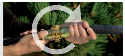
Zum Entkuppeln einfach die Kupplung und das Gegenstück in Axialrichtung zusammendrücken. Abschließend eine Kupplungshälfte in entgegengesetzter Richtung zum Kuppeln bis Anschlag drehen und vom Gegenstück abziehen.
